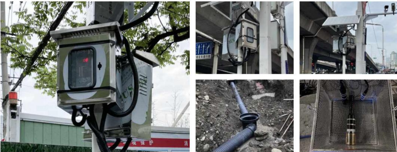
监测参数:COD、氨氮、pH、水位、太阳能供电、无线数据发送 仪器:OLK-C510电极、OLK-N100电极、LH-YB08、投入式液位计、太阳能供电系统、立杆、无线数据DTU传输模块
